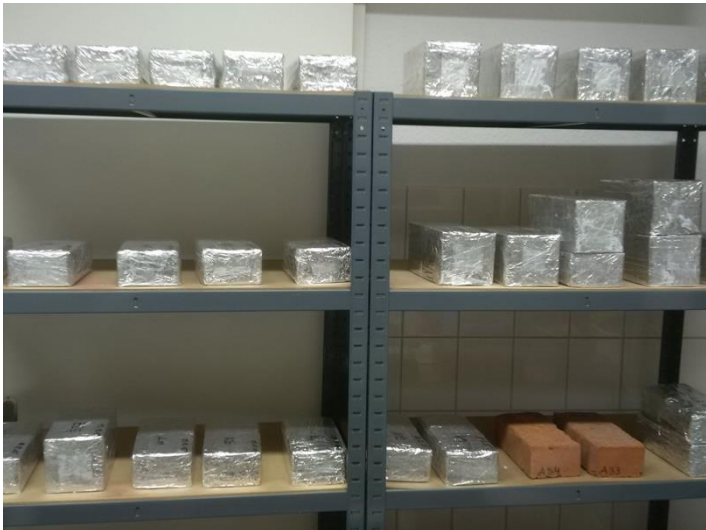
Injektionsmitteluntersuchung an Ziegelproben
